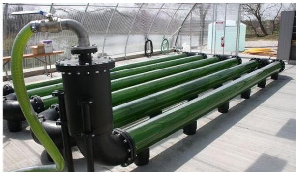
I principali sistemi chiusi commercialmente utilizzati sono i tubular photobioreactors (“fotobioreattori tubolari”, tPBR), i column photobioreactors (“fotobioreattori a colonna”, cPBR), e i flat panel photobioreactors (“fotobioreattori a pannello”, fpPBR).
