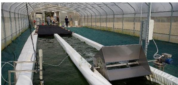
Sono generalmente costituiti da due canali in cui la coltura viene movimentata da una ruota a pale (10-12 pale, con un diametro totale di quattro volte la profondità dell'acqua, che ruota alla velocità di 10-20 rpm). La profondità dell'acqua varia da 0,2 a 0,4 m e lo scambio gassoso (rilascio di ossigeno e captazione di CO<sub>2</sub> per la coltura) avviene in uno specifico
